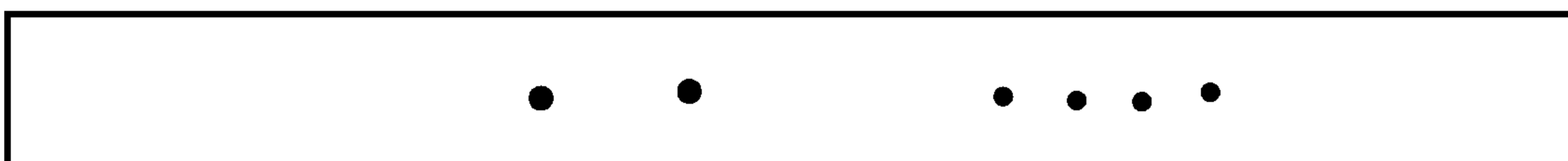
Пример 5 — две несплошности диаметром по 1,6 мм; четыре — по 0,8 мм
