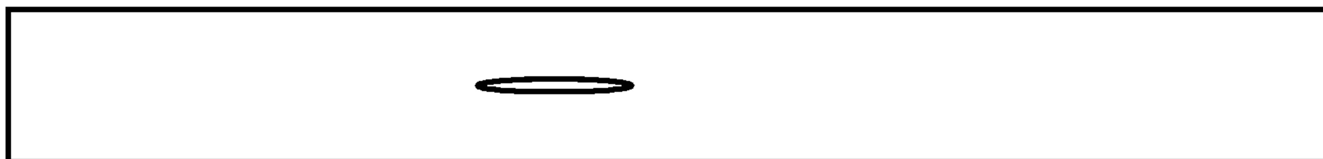
Пример 1 — одна несплошность длиной 12,7 мм
