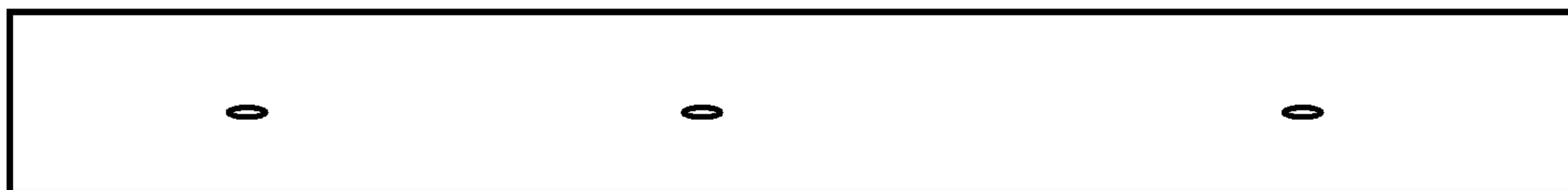
Пример 3 — три несплошности длиной по 3,2 мм
