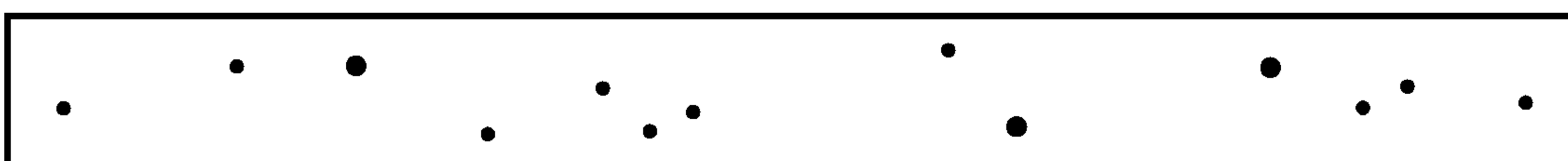
Пример 8 — три разбросанных несплошности диаметром по 0,8 мм; десять — по 0,4 мм
