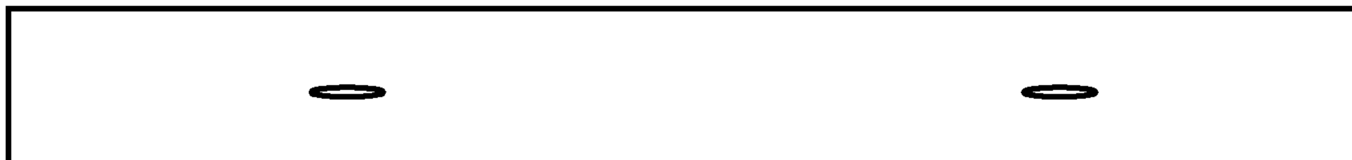
Пример 2 — две несплошности длиной по 6,4 мм
