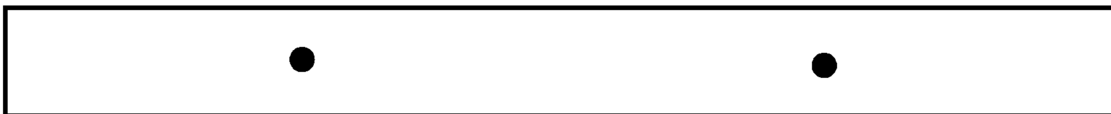
Пример 1 — две несплошности диаметром по 3,2 мм
