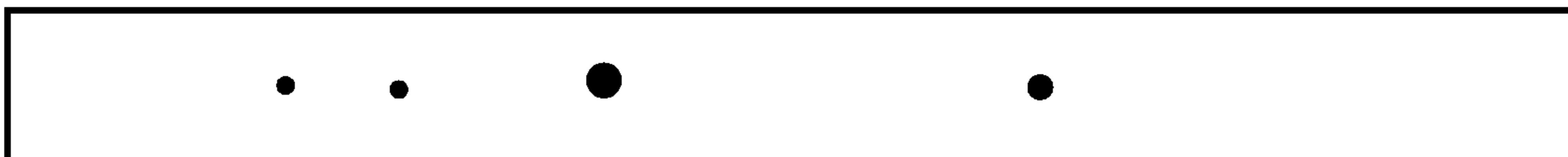
Пример 2 — одна несплошность диаметром 3,2 мм; одна — 1,6 мм; две — по 0,8 мм
